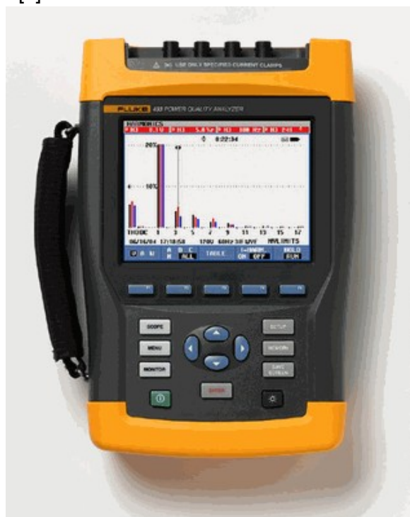
Rys.3. Analizator jakości energii elektrycznej serii Fluke 430 (trójfazowy)
