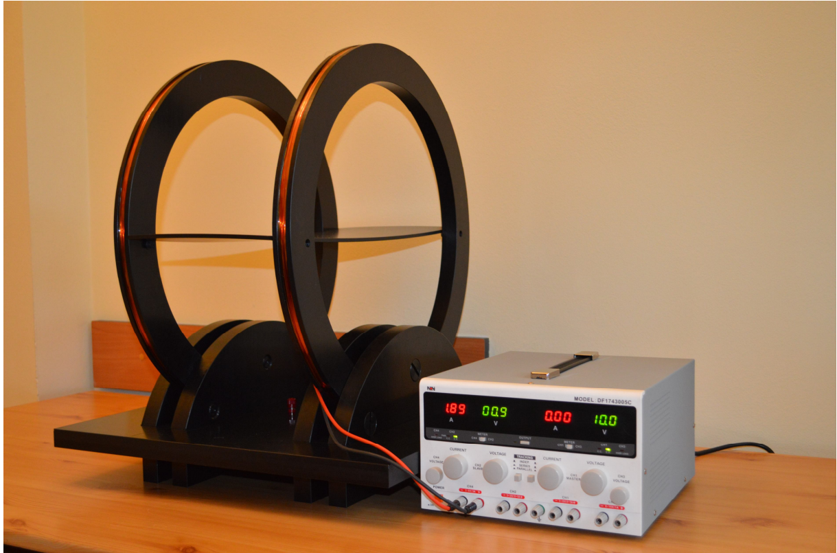
Widok ogólny cewki Helmholtza do wytwarzania wzorcowego pola magnetycznego w urządzeniu CH-100
